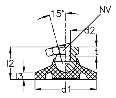
d1 = 25 d2 = M 8 l2 = 18.5 l3 = 4.0 NV = 12.0 Static load (N) = 5000 t min = 9.0
